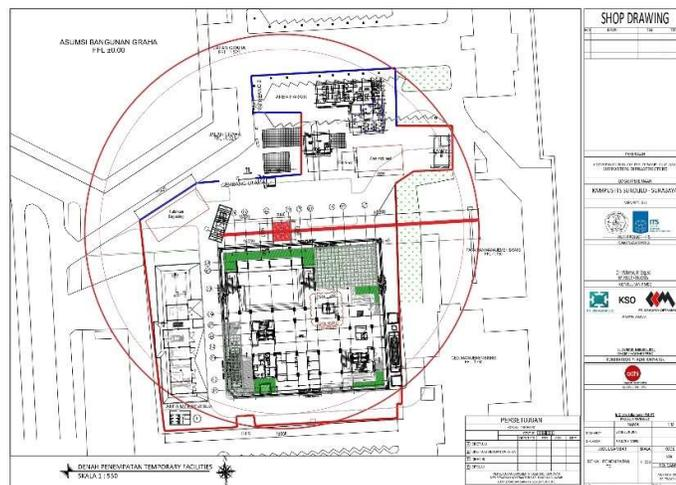
**Gambar 1. 1.** Perletakan Tower crane
