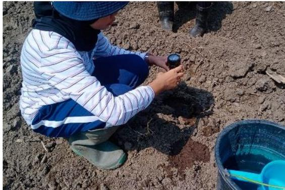
Gambar 5.2. Pengukuran pH Tanah
