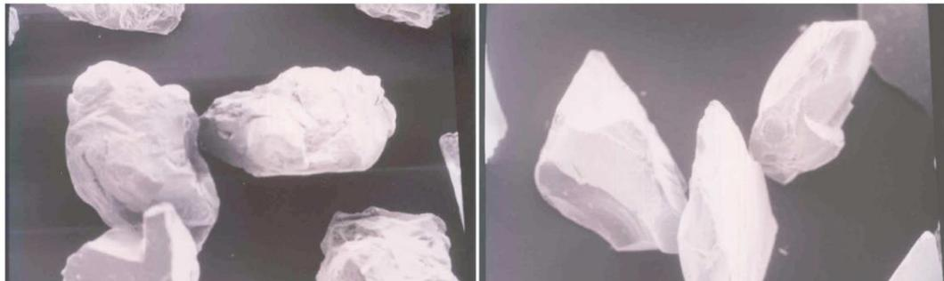
Gambar 2.8 Analisa SEM pada Pasir Silika (kiri) dan *Recycle Glass* (kanan)
