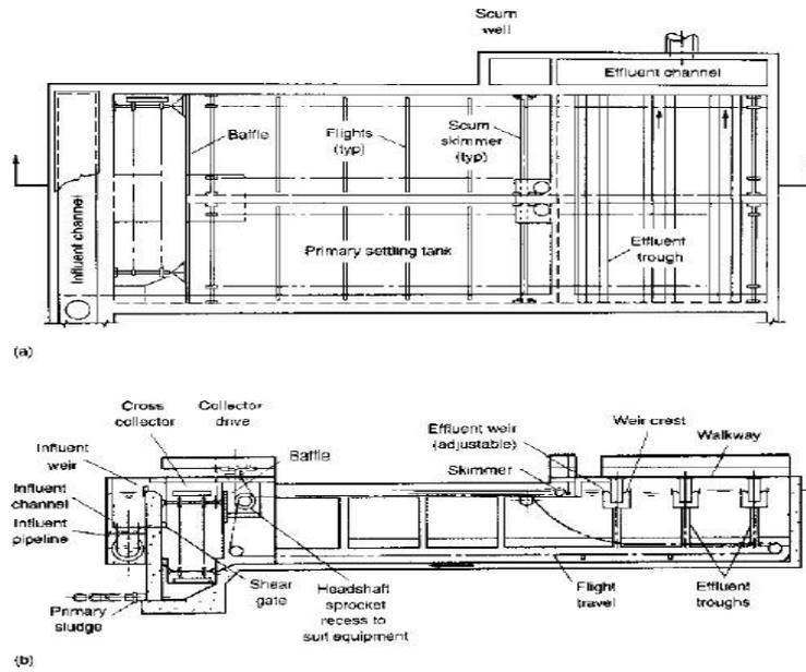
**Gambar 17.** Denah dan Potongan Sedimentasi Rectangular
