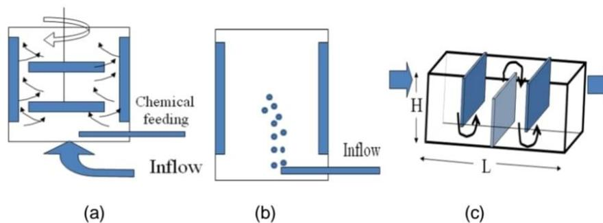
**Gambar 10.** (a) Pengadukan Mekanis, (b) Pengadukan Pneumatis, (c) Baffle
