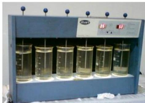
**Gambar 2. 20** penelitian laboratorium menggunakan jar tester
