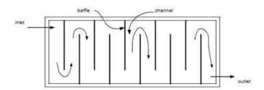
Gambar 2. 5 Baffle Channel untuk Pengadukan Lambat Sumber: (Masduqi & Assomadi, 2016)
