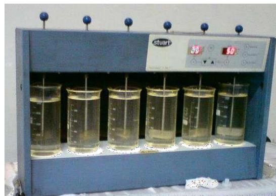
**Gambar 2. 21** Peralatan Jar Test
