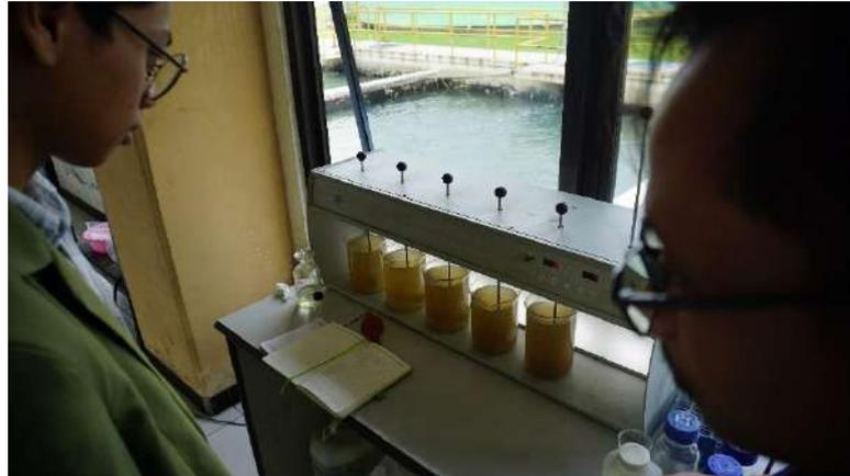
**Gambar 2.5** Jar Test untuk Menentukan Dosis Koagulan
