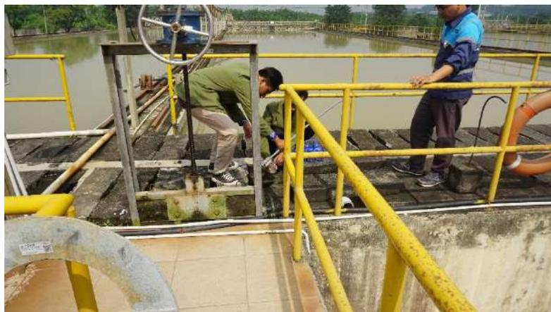
**Gambar 2.4** Pengambilan Sampel untuk Pengujian Operator dan Jar Test
