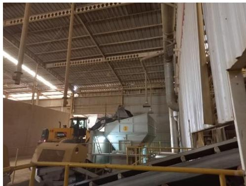
**Gambar 4.12** Memasukkan *Clay* ke Dalam *Feeder Box*
