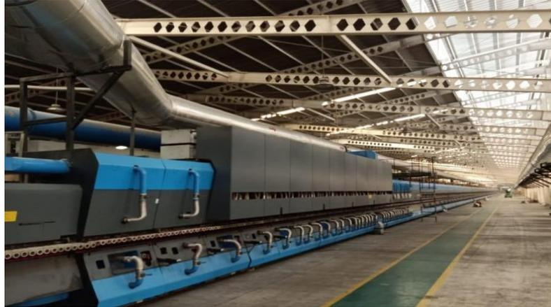
**Gambar 4.5** Proses Pembakaran Menggunakan *Kiln*
