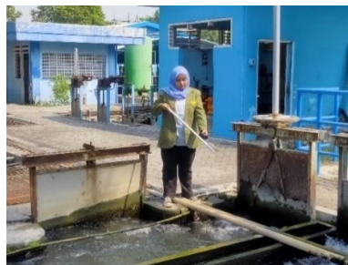
Gambar 2. 12 Pengambilan Sampel Outlet Prasedimentasi (Sumber: Dokumentasi pribadi, 2023)
