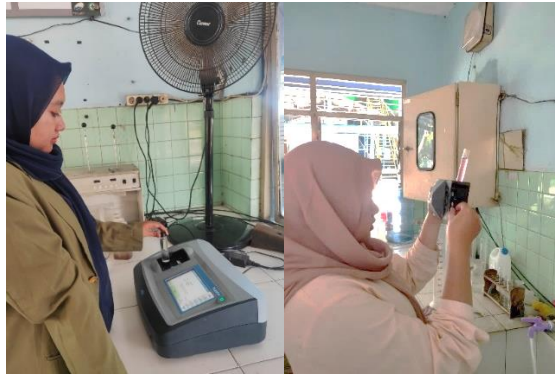
Gambar 2. 13 Pengujian Kekeruhan Air Baku dan Sisa Klor (Sumber: Dokumentasi pribadi, 2023)
