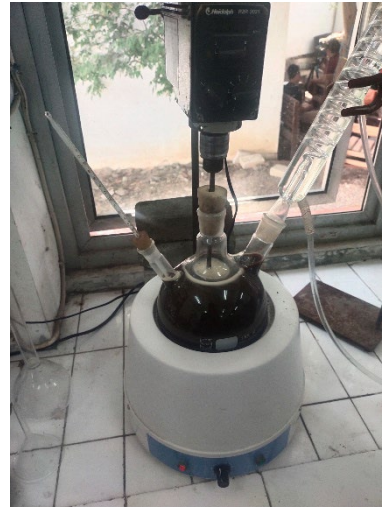
Gambar 2. Proses Hidrolisis Asam untuk Menghasilkan Glukosa
