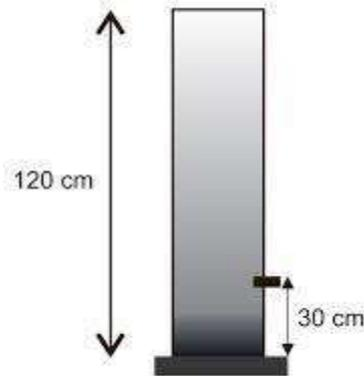
**Gambar 2. 15** Kolom Test Sedimentasi Tipe II
