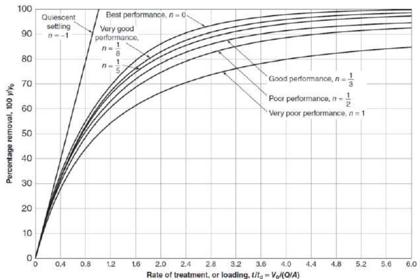
**Gambar 2. 17** Grafik Kecepatan Pengendapan Partikel pada Sedimentasi
