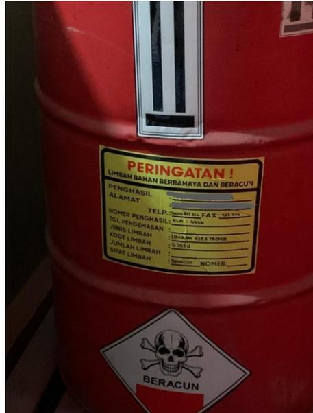
**Gambar 3.4** Kemasan yang Digunakan oleh PT X untuk Menyimpan Limbah B3 Jenis Elektronik Bekas
