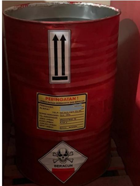
**Gambar 3.2** Kemasan yang Digunakan oleh PT X untuk Menyimpan Limbah B3 Jenis Kemasan Bekas B3
