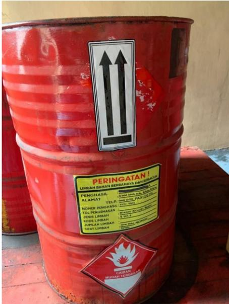
**Gambar 3.13** Contoh *Detail* Kemasan Drum Logam Limbah B3 dengan Satu Karakteristik pada PT X
