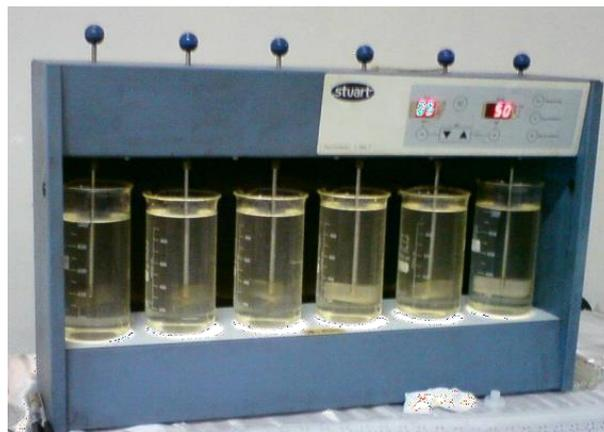
**Gambar 2.6** Peralatan *Jar Test*
