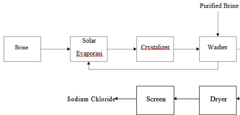
**Gambar II.4 Proses Solar Evaporasi**
