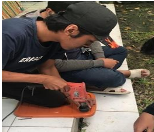
Gambar 20. Pelubangan pada bagian tutup container
