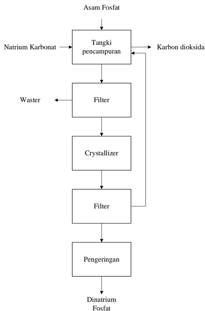
Gambar II. 1 Blok Diagram Proses Kristalisasi
