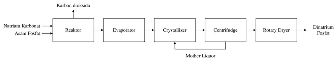
Gambar II. 3 Blok Diagram Proses Produksi Dinatrium Fosfat
