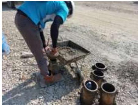
Gambar 7. 37 Proses Memasukkan Beton Cair ke Cone
