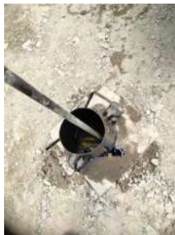
Gambar 7. 38 Proses Menusuk Bagian dalam Cone
