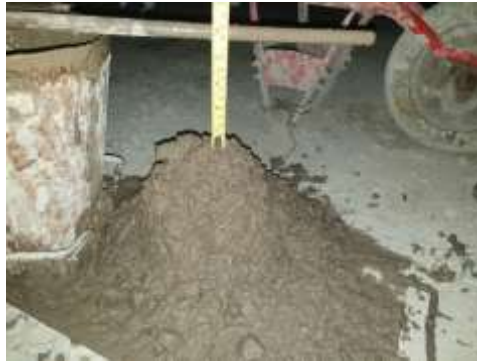
Gambar 4. 9 Slump Test Beton Sebelum Dicampur Sika Viscocrete-3115N
