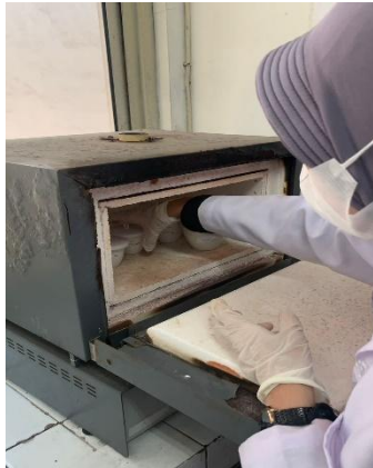
Gambar 13. Kalsinasi dengan furnace bersuhu 700 selama 2 jam
