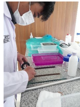
Gambar 4. Proses preparasi plat kaca untuk percetakan membran
