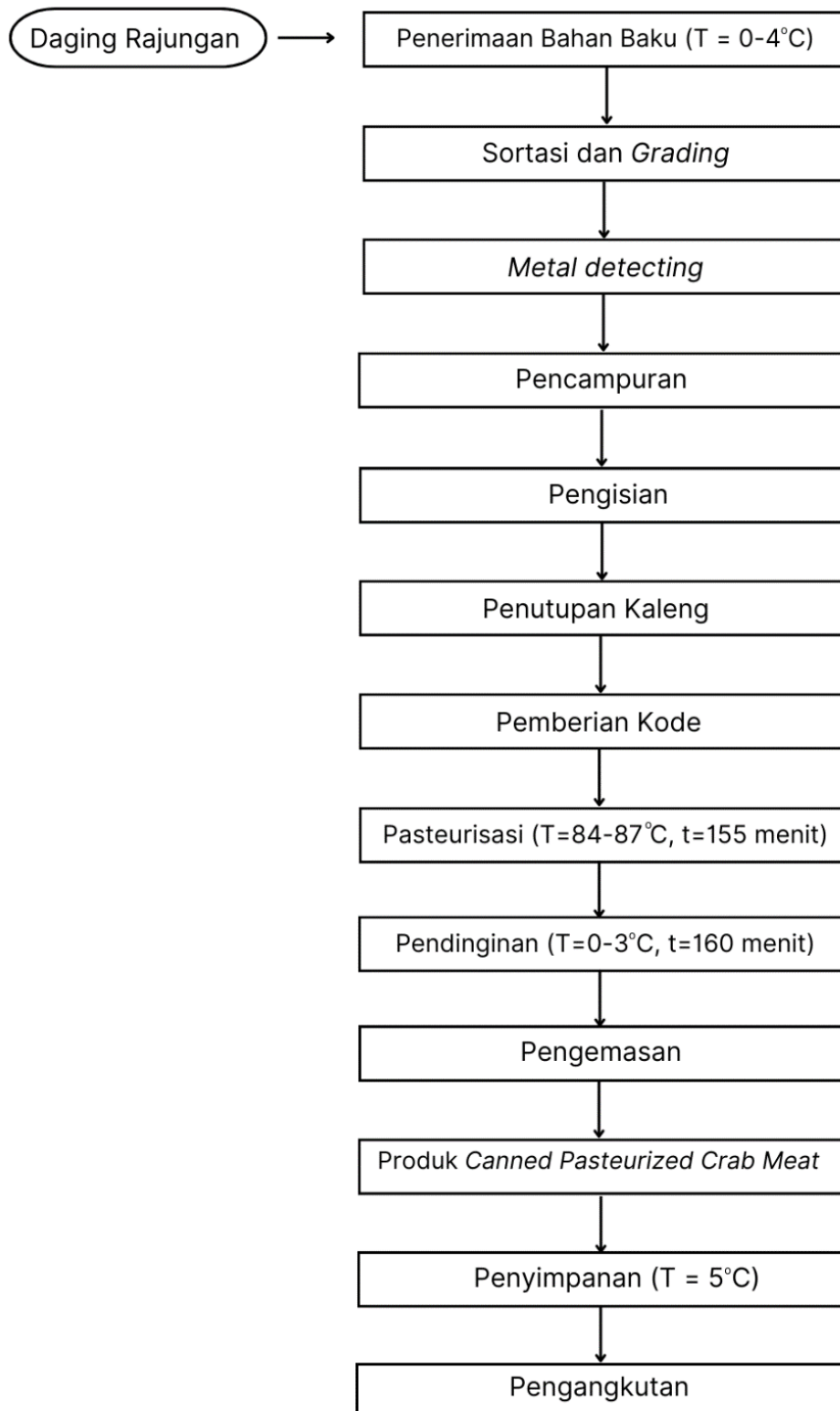
Gambar 6. Diagram Alir Proses Pengalengan Rajungan
