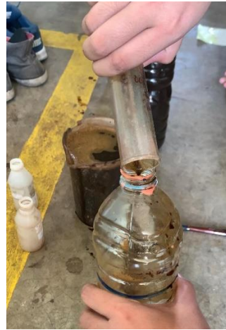
Gambar 6 Pencampuran Sludge dengan tetes sesuai variabel
