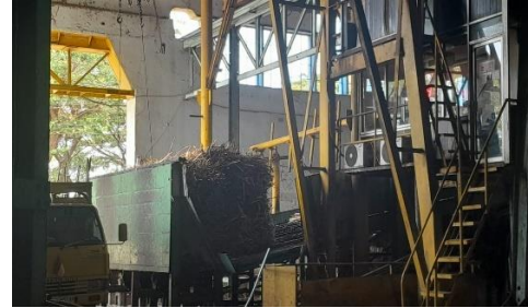
Gambar 2. Proses Pengangkutan Tebu dari Truk menuju Cane Table
