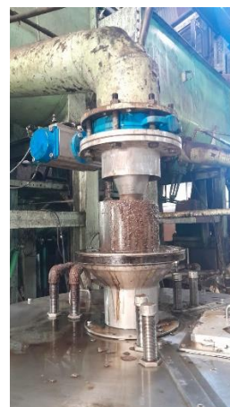
Gambar 6. Proses Pemuteraan Nira Pada LGF / HGF di Stasiun Puteran
