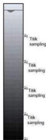
**Gambar 2. 25** Kolom Test Sedimentasi Tipe II
