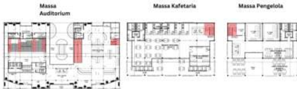
Gambar 6.12 Peletakan tangga & Ramp
