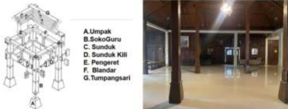
Gambar 2. 40 Struktur pendopo PAS
