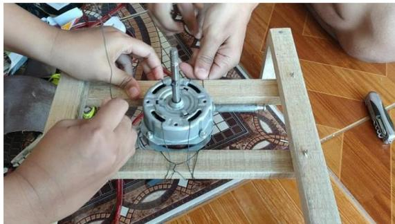
**Gambar 5.** Memasang Dinamo di Kerangka Kayu
