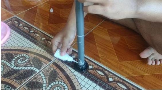
**Gambar 13.** Memasang Pipa Paralon ke Toples Bagian Luar
