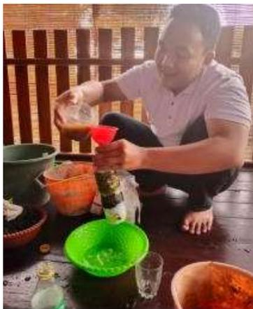
Gambar 25. Proses Penyaringan Air Menggunakan Sampel Air Keruh
