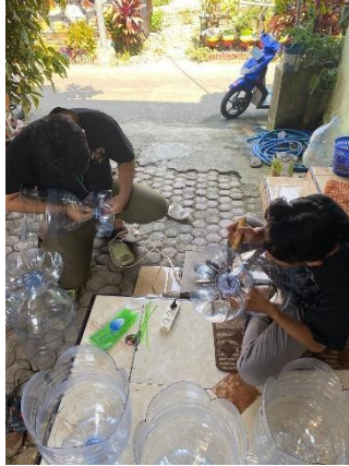
Gambar 18. pelubangan alaspot dengan solder
