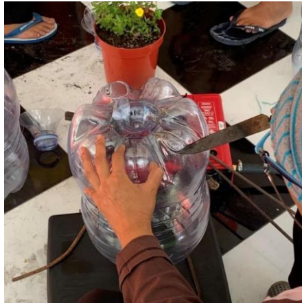
Gambar 3. Memotong sisi bawa galon air dengan pisau yang dipanaskan
