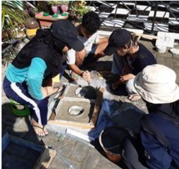
Gambar 5. Mengisi cetakan biopori dengan campuran semen dan pasir
