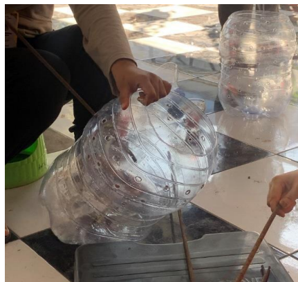
Gambar 2. Melubangi sisi galon air dengan besi panjang yang dipanaskan
