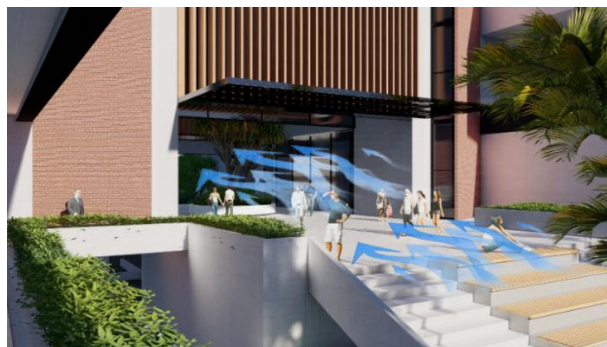
Gambar 6. 24 Ilustrasi Arah Masuk Angin Ke Dalam Bangunan Sumber: Ilustrasi Pribadi 2024
