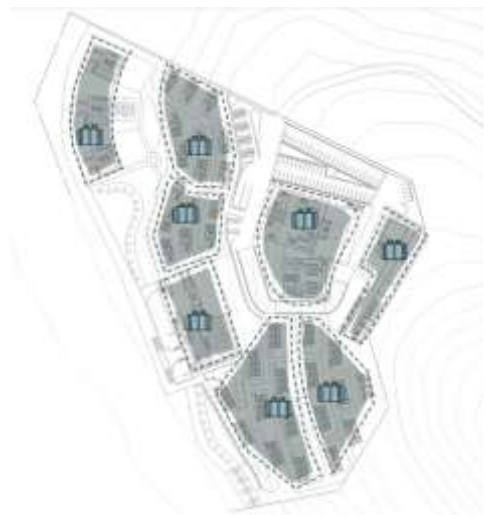
Gambar 6. 18 Peletakan Septic Tank
