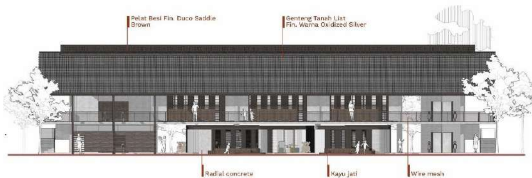
Gambar 6.17. Aplikasi Material pada Tampilan Bangunan Sumber: Analisis Pribadi, 2024
