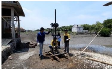
Gambar 2.5 Uji Sondir Boring Titik 1
