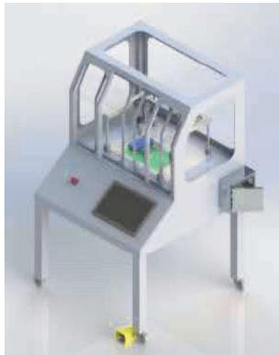
Gambar 5.1 Mesin Inovasi *Liquid Handling System* dengan Tambahan *Enclosure* dan Pijakan Kaki Samping
