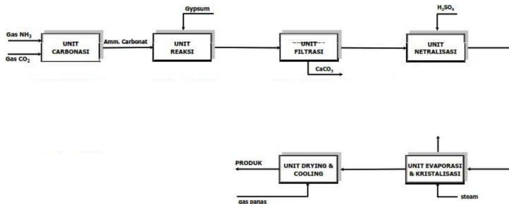
Gambar II. 3 Diagram Alir Proses Produksi Ammonium Sulfat
