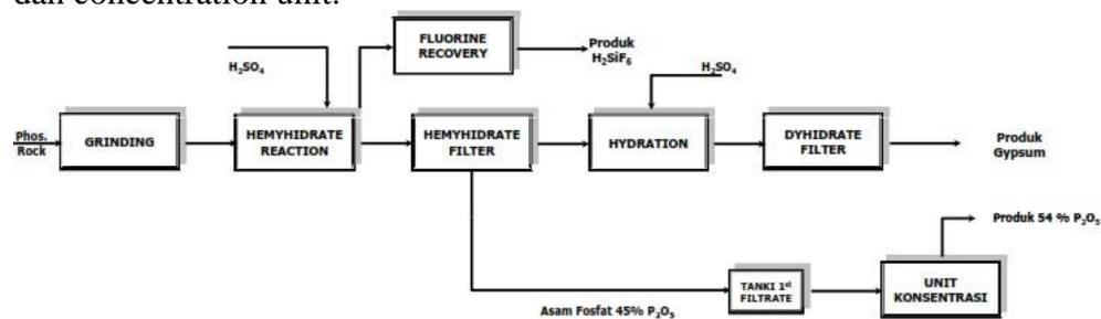
Gambar II. 2 Diagram Alir Produksi Asam Fosfat
