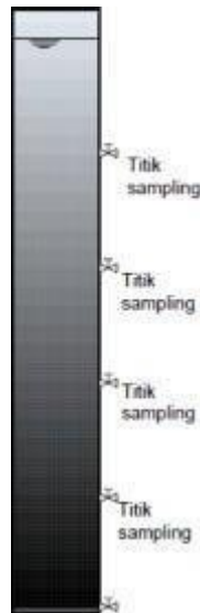
Gambar 2. 15 Kolom Test Sedimentasi Tipe II
