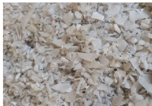
Gambar IX.2 Flake Plastik Sebelum dan Sesudah Pencucian
