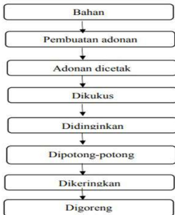
Gambar 2.7. Tahapan Pengolahan Kerupuk Sumber : Kemal, 2001
