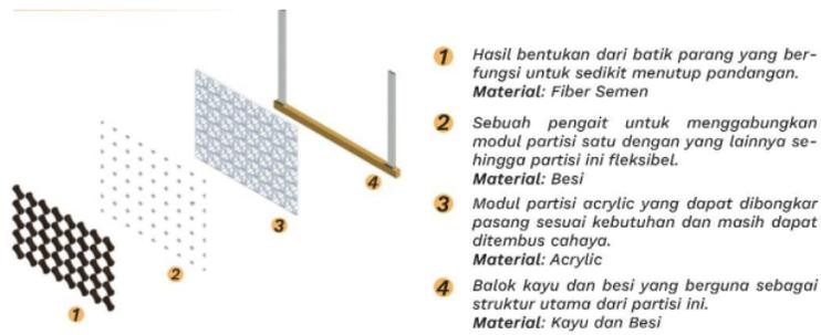
Gambar 3. Aksonometri Dinding Partisi Interior
