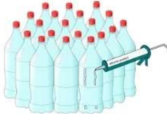
Gambar 15. Botol ecobrick dirangkai
