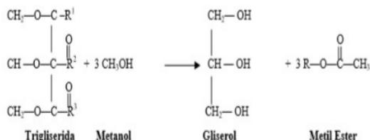
Gambar 1. Reaksi transesterifikasi biodiesel [3].
