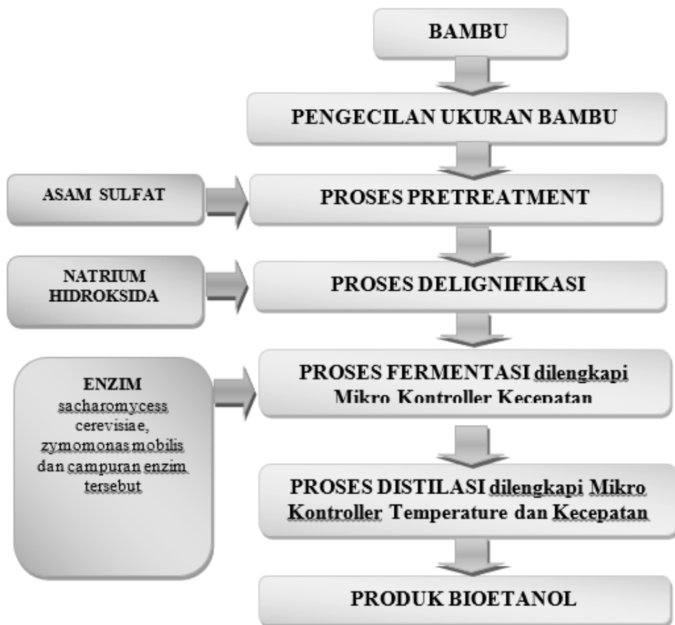
Gambar 4.1. Blok diagram produksi bioetanol berbahan baku bamboo dilengkapi mikro kontroller
