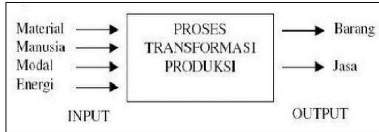
Gambar 2.1 Skema Sistem Produksi
