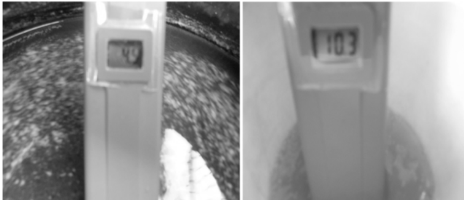
Gambar 1.4. Mengukur pH limbah cair pabrik tepung beras
