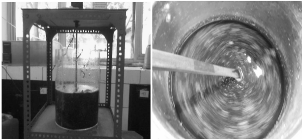
Gambar 1.6. Proses hidrolisis limbah cair pabrik tepung beras
