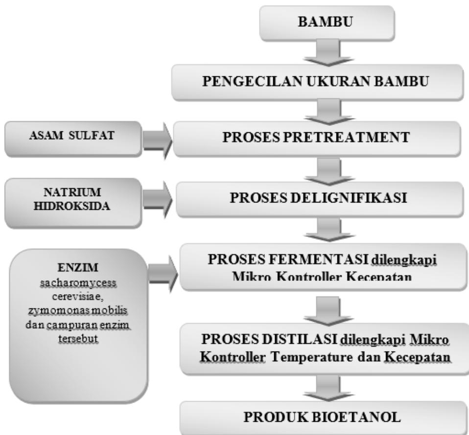
Gambar 4.1. Blok diagram produksi bioetanol berbahan baku bamboo dilengkapi mikro kontroller
