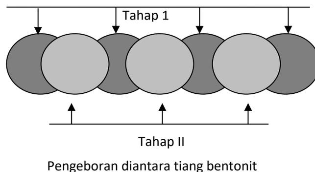
4. Bila struktur secant pile diperlukan sebagai struktur penahan tanah selama proses penggalian, maka untuk tiang yang tahap kedua di cor beton bertulang (sebagai struktur penahan).
