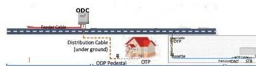
Gambar 3.17 Sistem jaringan hardware Fiber Optic dari pusat sampai ke end user melalui jalur bawah tanah
