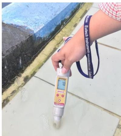
Gambar 5. 9 Pengukuran pH
