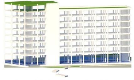
struktur pada hotel menggunakan sistem core dan rigid frame dengan pondasi tiang pancang
